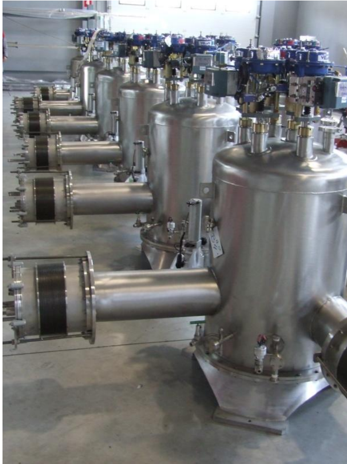
Boîtes à vannes réalisées et stockées chez le constructeur
