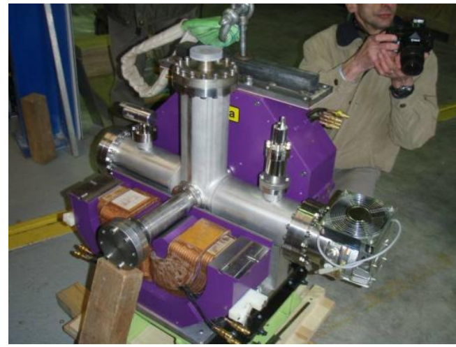
Installation de la boîte diagnostic entre le doublet de Q-pôle
