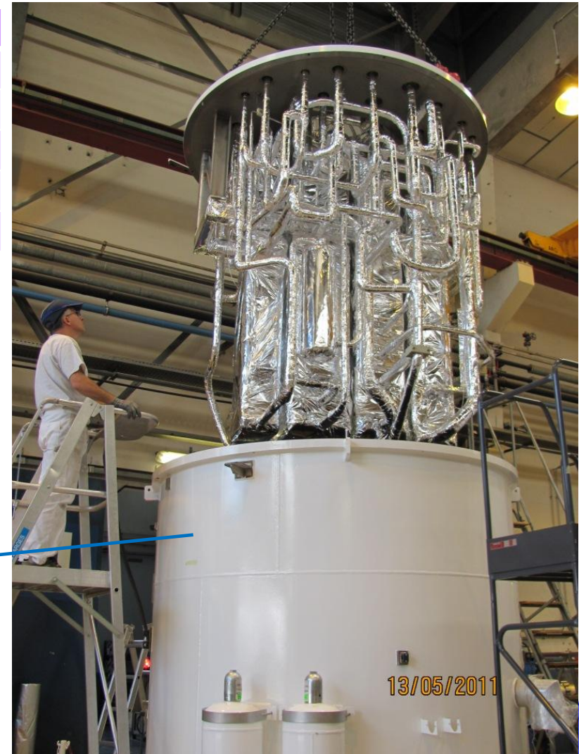
Boîte froide en cours de réalisation
